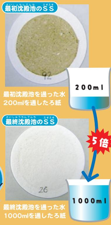
毎日決まった時間の水と、24時間採取して混ぜた水(平均的な水)を測定しています。流入水、最初沈殿池の水、最終沈殿池の水、放流水等を毎日分析しています。
